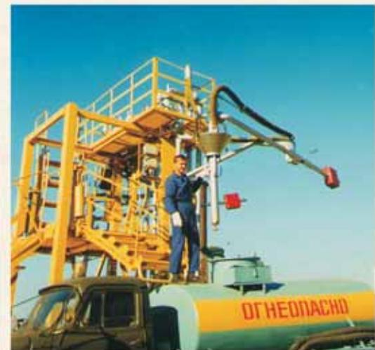
Идут испытания наливной эстакады
