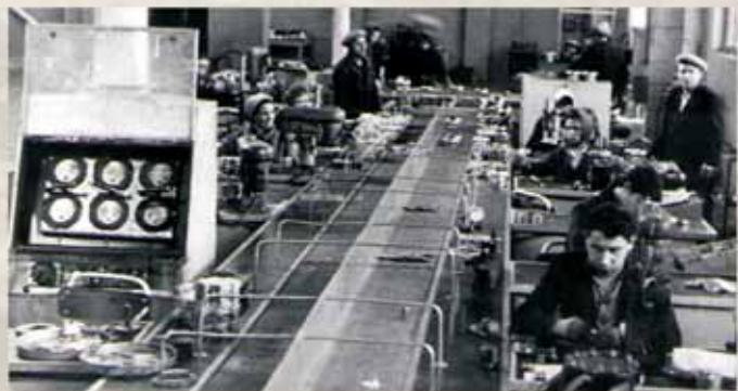
Конвейер для сборки счетных головок
